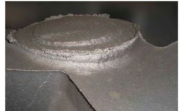
Bild 2: Ausgangssituation: konventionelle Speisungstechnik ohne Brechkern (Stahlguss)
