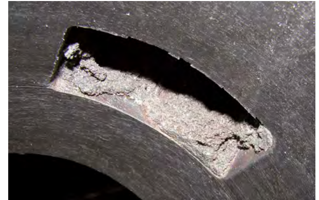
Bild 4: Steuerkanal mit Vererzungen (Kern aus Chromerzsand)
